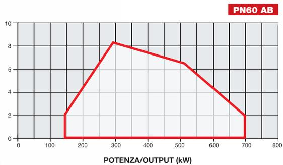
Contropressione in camera di combustione (mbar)
